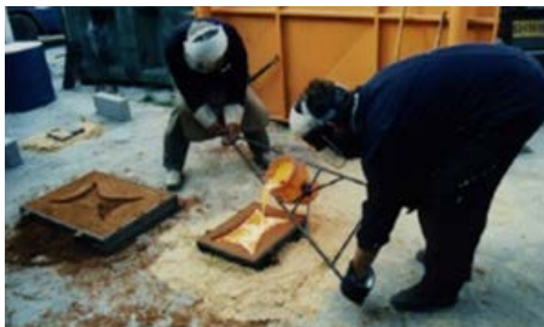
Coulée expérimentale de cuivre fondu visant à obtenir un lingot en forme de peau de bœuf. Image avec l'aimable autorisation de V. Kassianidou.
